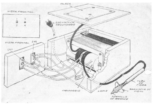
El primario se bobina directamente sobre el núcleo, envolviendo previamente al mismo con varias capas de papel presspan para aislarlo.
